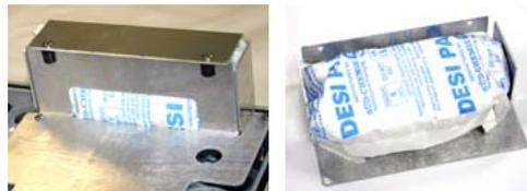
Abbildung 4-1 Den internen Trockenmittelbeutel entfernen
