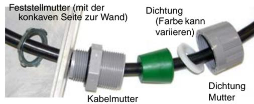
Abbildung 3-4 TIENet-Kabel mit einem Zugentlastungsfitting installieren
