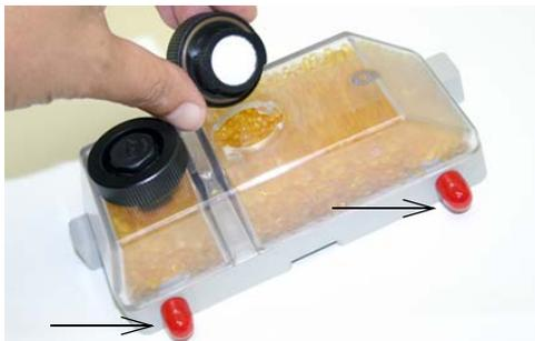
Abbildung 4-5 Die Kammern der Trockenmittelbehälter öffnen
