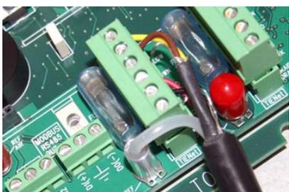
Abbildung 3-7 Kabelreferenzschlauch in den Leiterplatten-Referenzanschluss einführen (System mit TIENet 350)
