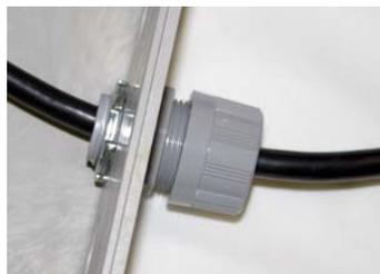
Abbildung 3-8 Positionieren und fixieren Sie das Kabel
